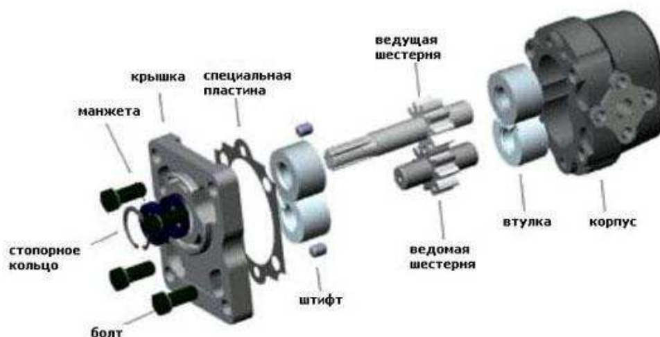
Рис. 4 Детали шестеренного насоса
