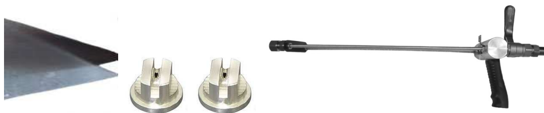
Рис.6 Распылительный пистолет, форсунки, пересекающиеся факелы жидкостей.
